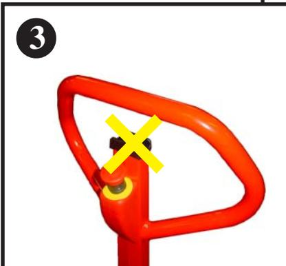
Manuelle Bedienung der Deichsel ist bei aktivierter Positionskontrolle nicht möglich.
