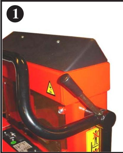
Die Bremse ist zu betätigen, bevor die Positionskontrolle angewendet werden kann.
