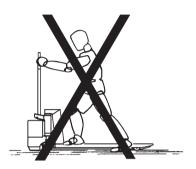
**3.4 Notbremsung**Wenn es notwendig wird, die Last als Bremse zu verwenden, um den Scherenhubwagen am Wegfahren zu hindern, ist der AB-Knopf schnell zu bedienen, bis die Last auf den Boden abgesenkt ist.
