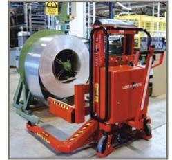
Logiflex mit Breitspurfahrwerk und festem Fassgabelträger für das Transportieren von schweren Rollen (große Durchmesser).
