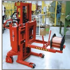
Logiflex mit seitlich verschiebbarem Träger und längs verschiebbarem Schlitten zur Spulenübergabe.
