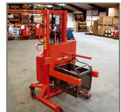
Logiflex mit Seitenkippgabeln und Dorn für das Heben und Kippen von Drahtkörben.
