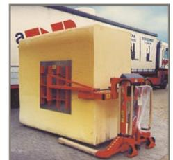
Logiflex mit Breitspurfahrwerk und Greifarmen für Schaumstoffblöcke.
