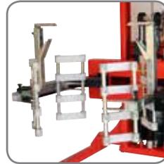
Flexible, spezial-entwickelte Greifarme lassen sich je nach dem Typ und dem Durchmesser des Fasses einstellen.
