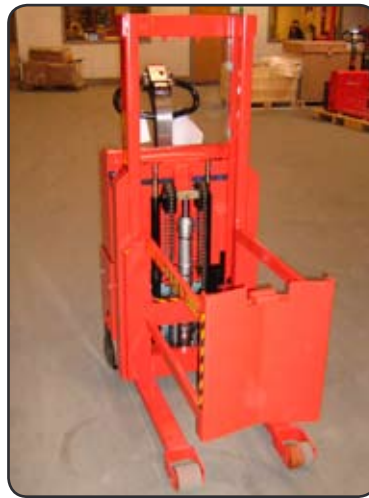
SELF mit speziellem Fassheber. Der eine Deichselgriff des Fasses wird zum Festhalten des Fasses verwendet. P07267-2
