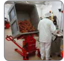
Korrekte Arbeitshaltung beim Entleeren von Gitterboxen und Kästen - sowohl sitzend als auch stehend.
