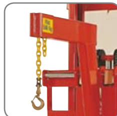
Die Kettlänge lässt sich einfach und schnell einstellen.
