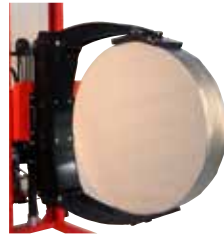
Versehentliches Öffnen der Greifarme nicht möglich. Deutliche Angabe, ob die Klemmkraft für Heben/Rotation ausreichend ist.
