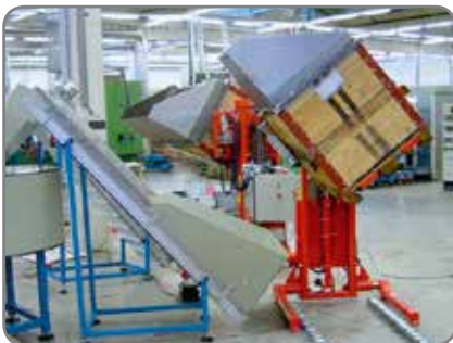
Logiflex mit Seitenkippgabeln für das Heben und Entleeren von Behältern.
