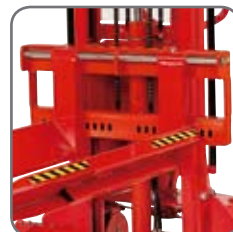
Fassgabeln werden an einem speziellen Gabelträger angebaut.
