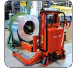
Logiflex mit Breitspurfahrwerk und festem Fassgabelträger für das Transportieren von schweren Rollen (große Durchmesser).
