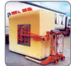
Logiflex mit Breitspurfahrwerk und Greifarmen für Schaumstoffblöcke.
