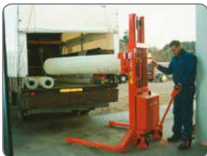
Ein Breitspur-Logiflex beim Handeln von Rollen vom Lager zum LKW.
