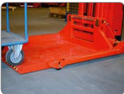
Die Auffahrrampe der Plattform vereinfacht das Auffahren.
