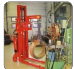
Coils werden zu einer Stanzmaschine transportiert.
