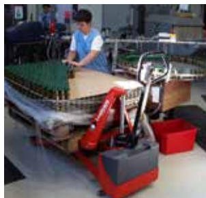
Der elektrische Scherenhubwagen hat zentrale Anordnung des Notausschalters. Die Gabeln stoppen schnell und präzise.
