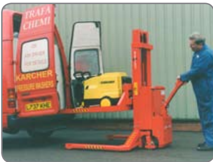
Die Plattform hier beim Transport eines Hochdruckreinigers.
