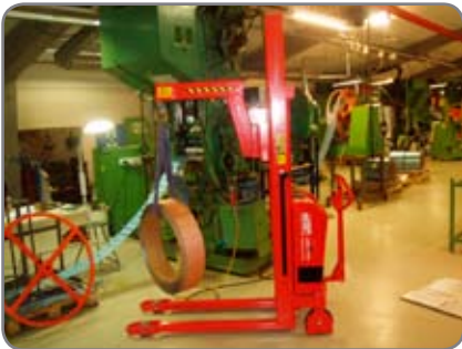
Der Kranarm beim Einsatz in der Komponentenherstellung.
