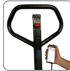
Die Kippfunktion wird durch die Kabelfernbedienung gesteuert.
