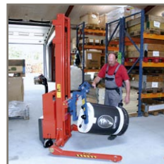
Der Rollenkipper beim Einsatz in der Verpackungsindustrie.
