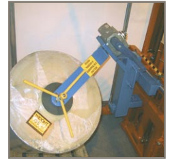
Der Rollenkipper funktioniert mit Schneckengetriebe mit Handkurbel für die Drehfunktion und Handkurbel für den Spanndorn.
