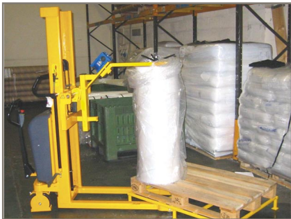
Der Rollenkipper beim Einsatz in der Verpackungsindustrie.
