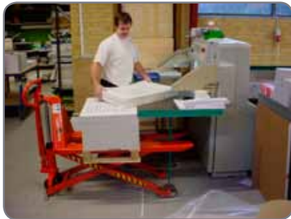
Der manuelle Scherenhubwagen hat sehr niedrige Pumpkraft, Fußschutz und Neutralstellung.
